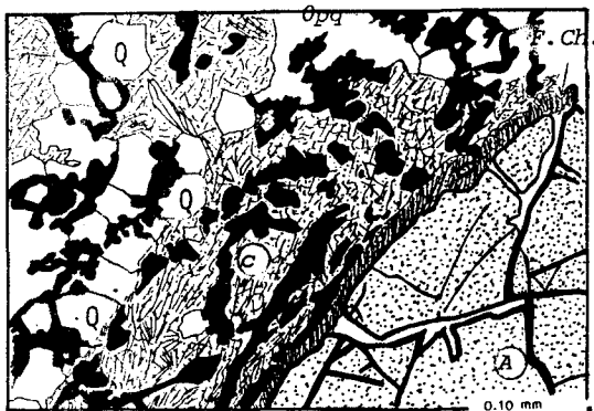
Figure 3 : Cornéenne de l'auréole des Zaër (zone Nord). Au contact entre l'andalousite (A) et la cordiérite (C) se développe un liseré réactionnel de fibres chloriteuses (f.ch.) sur fond de quartz (Q) encombré d'opaques ferrugineux (Opq).
